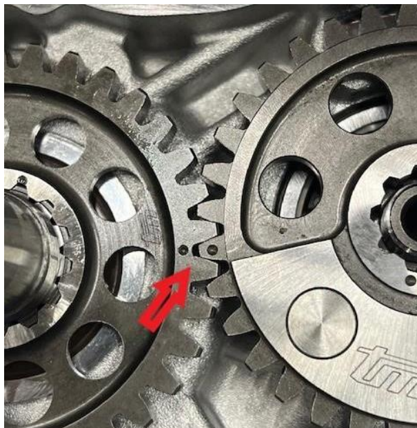
Figura 2: Montaggio degli ingranaggi del contralbero.
